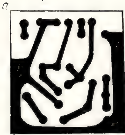
Rys. 14. Płytki układu sterowania wskaźnikiem wychyłowym (a - schemat, b - rozmieszczenie elementów) - widok od strony druku
